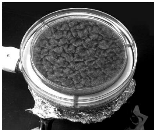
Abb. 6: Versuchsaufbau mit Wasserbad in Petrischale auf Kochplatte
