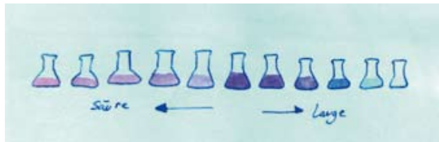
Farbindikation durch Rotkohlsaft: von sauer bis basisch
