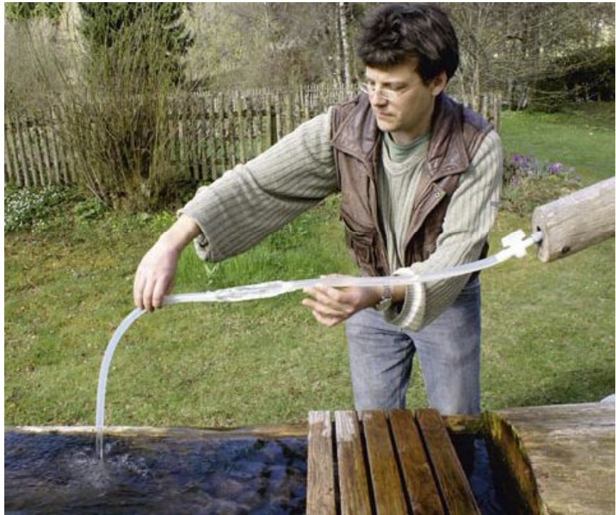
Abb. 10: Pulsierender Schlauch, Freihand-Versuch am Brunnen
