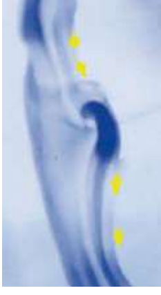
Abb. 9: Abschnürung des Zwischenwirbels vom Girlandenringwirbel. Axiale Strömung gelb markiert. Siehe Kreis in Abbildung 7
