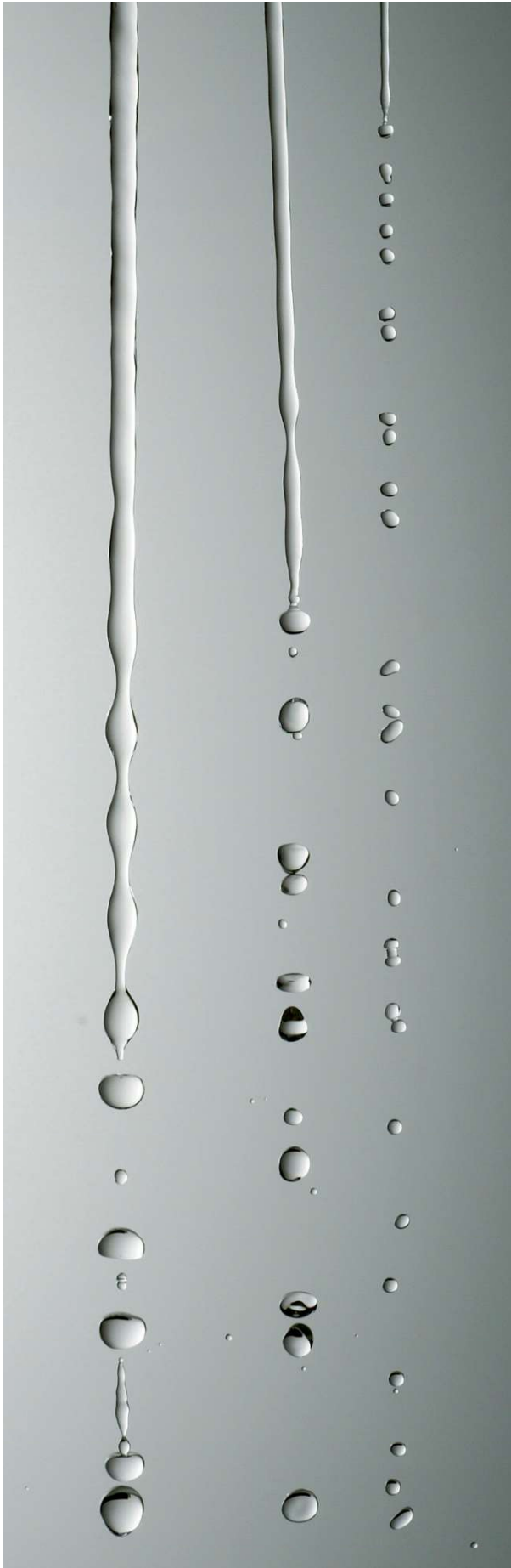
Abb. 8: Drei unterschiedlich dicke Wasserstrahlen. Mit bloßem Auge sind die einzelnen Tröpfchen nicht zu sehen, die Strahlen erscheinen kon- tinuierlich. Beim Aufprall verraten prasselnde Geräusche, dass sie nicht kontinuierlich sind.
