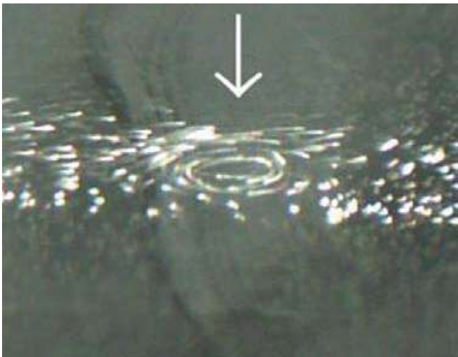
Abb. 11: Die Drehrichtung des Ringwirbels zeigt diese Aufnahme, siehe Pfeil. Es wurden Partikel in einem Lichtschnitt beleuchtet. Die Blitzbeleuchtung begann hell und klang nach einer 1/1000 Sekunde ab. Daraus ergibt sich im Foto eine Drehung im Uhrzeigersinn. Das Bildzentrum ist rechts.
