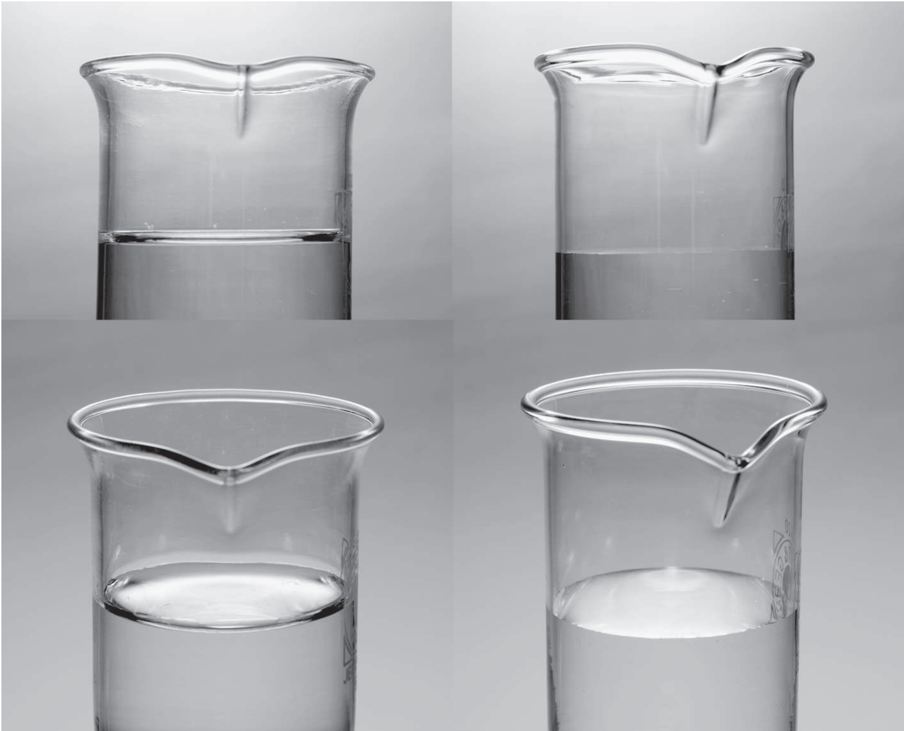
Abb. 16 links: Das Wasser ist am Glas aufgestiegen, ein Meniskus hat sich gebildet. Rechts: Das Glas benetzt nicht, die Wasseroberfläche bildet einen rechten Winkel mit dem Glas. Unten: an den Lichtspiegelungen auf den Wasseroberflächen ist der Unterschied gut zu erkennen.
