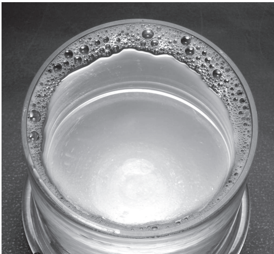
Abb. 17: Luftblasen steigen im Meniskus auf und sammeln sich dort an.
